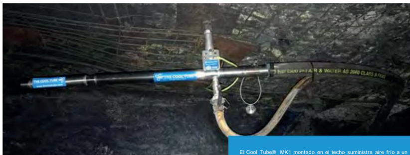
El Cool Tube® MK1 montado en el techo suministra aire frío a un espacio de trabajo.
