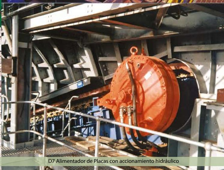
D7 Alimentador de Placas con accionamiento hidráulico
