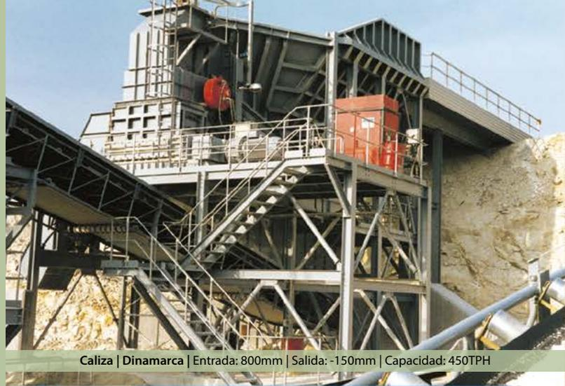
Caliza | Dinamarca | Entrada: 800mm | Salida: -150mm | Capacidad: 450TPH
