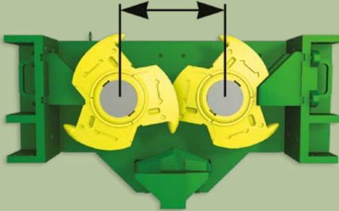
La distancia entre centros combinada con la configuración de los dientes controla el tamaño máximo del material de alimentación que el equipo puede procesar con eficacia.
