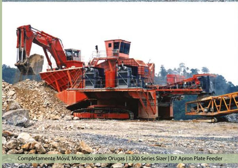
Completamente Móvil, Montado sobre Orugas | 1300 Series Sizer | D7 Apron Plate Feeder
