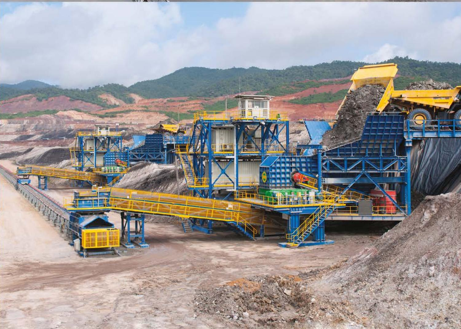
Estación Sizer Semi Móvil con doble plataforma para camión / Sizer Serie 1150 / Alimentador de Placas D7
