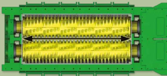
La longitud de la entrada tiene un efecto importante sobre el volumen de material que el equipo puede procesar.
