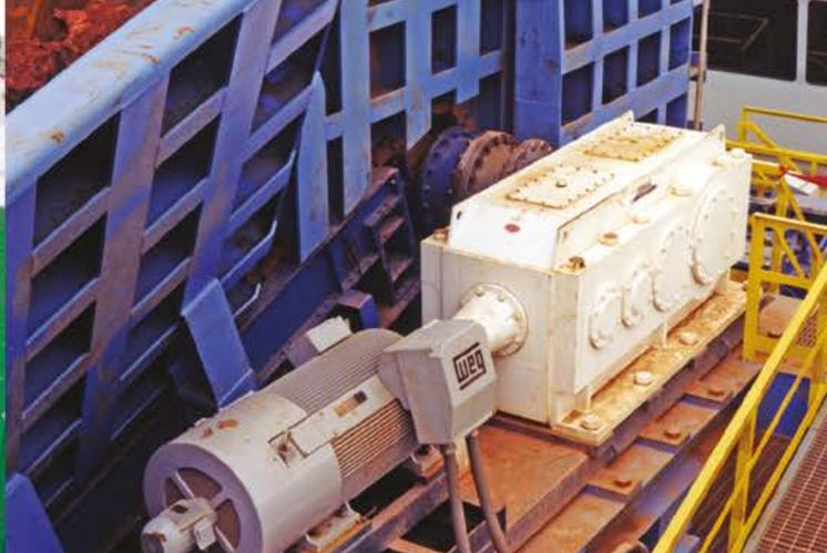
D7 Alimentador de Placas con accionamiento electro-mecánico
