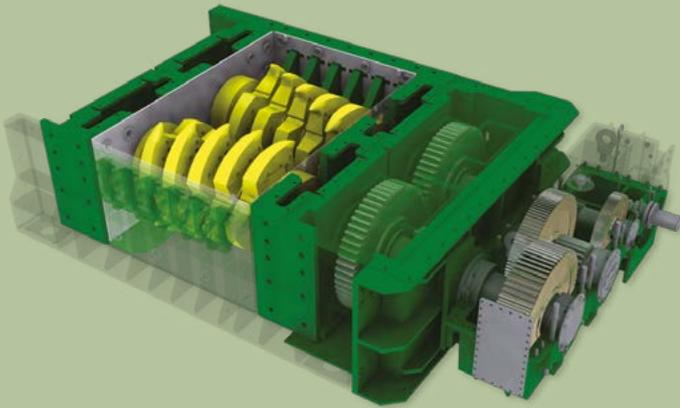
Se diseñó la Serie 1000 para proporcionar una gama de máquinas primarias entre la Serie 750 y la Serie 1300 de gran tonelaje. La distancia extra entre los centros permite que maneje un mayor tamaño de alimentación, aumentándose considerablemente la capacidad con la misma longitud de entrada, que además puede ser variada.
