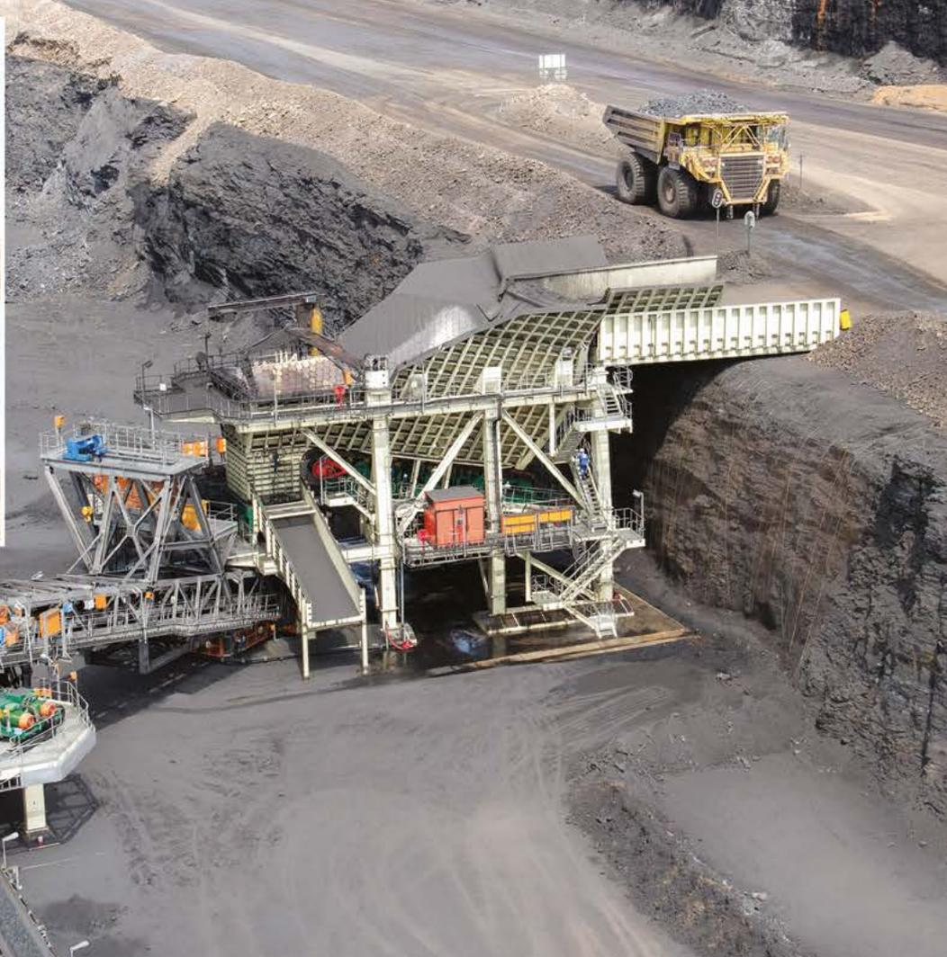
Estación Sizer Semi Móvil con una plataforma para camión / Reubicada por el Transportador MMD Atlas 500T (recuadro)
