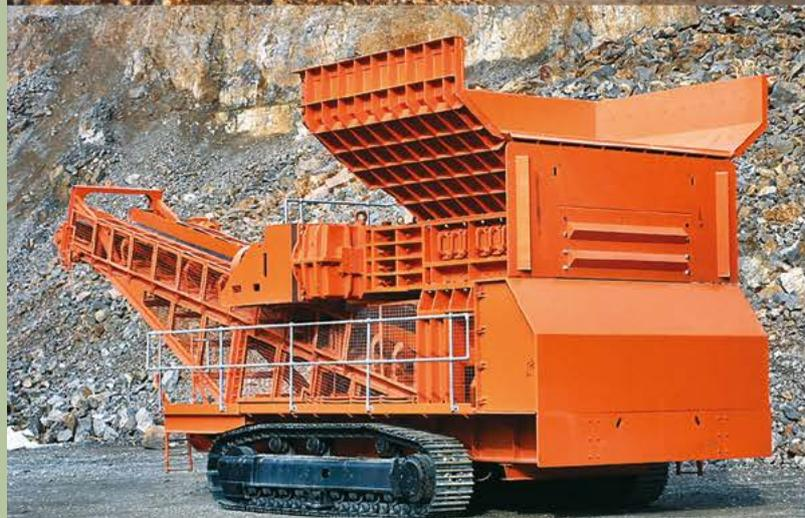
Completamente Móvil, Montado sobre Orugas | Sizer de la Serie 750
