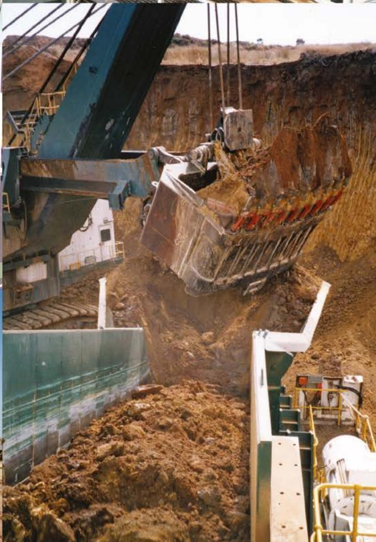
D9 Alimentador de Placas con accionamiento electro-mecánico
