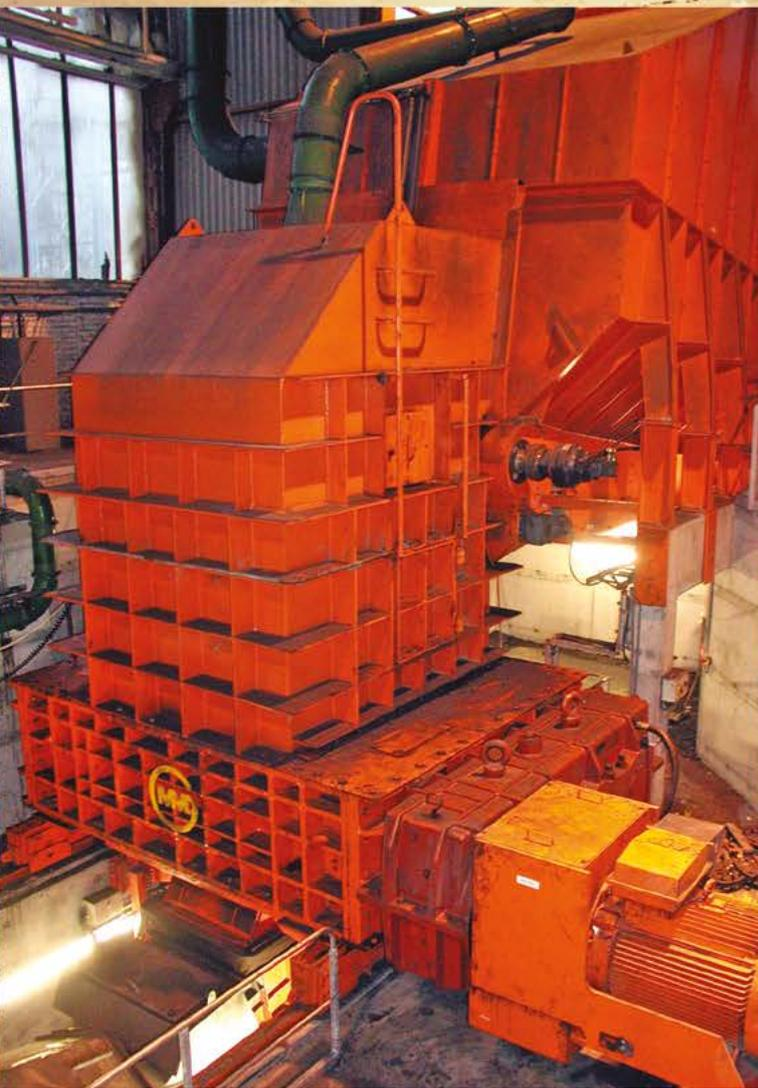
Ánodos de Carbón | Noruega | Entrada: 1.600mm | Salida: -350mm | Capacidad: 70TPH
