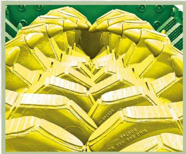
El sistema helicoidal de dientes de apertura profunda transporta el material de mayor tamaño hasta un extremo de la máquina, ayudando a extender la alimentación a través de la longitud total de los rotores. Se puede emplear dicha característica también para rechazar material de sobre tamaño de la máquina.
