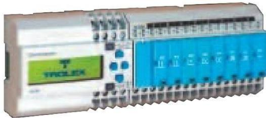
SISTEMA DE E/S DISTRIBUIDO COMMANDER para sistemas de monitoreo de plantas generales a gran escala y para las industrias de minería y construcción de túneles.
