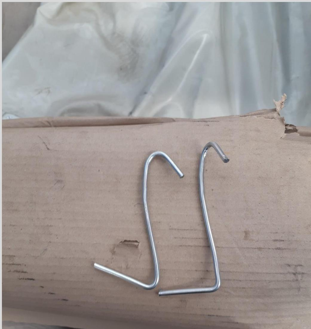
**Deformación gancho con 75 kilos de peso**
