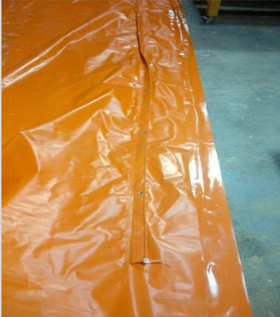
La colocación de la suspensión es un proceso en el cual se sella por alta frecuencia la cual funde las telas a nivel molecular permitiendo que el ducto se pueda colgar en la faena o mina respectiva.
