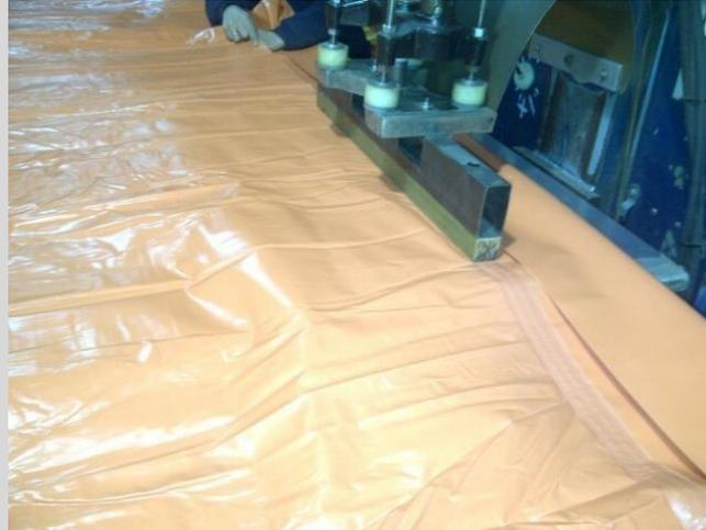
La unión de paños se realiza según el diámetro del ducto que se está trabajando. Este proceso se realiza a través de máquinas selladoras de PVC, las cuales realizan el sellado a nivel molecular fusionando las telas, a través de este proceso nos cercioramos que no presentara problemas en las uniones de los paños.
