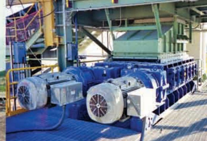
Bórax | EE.UU | Entrada: 250mm | Salida: -75mm | Capacidad: 1.600TPH
