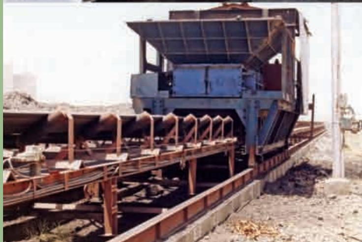
Trituradora de la Serie 500, Semi-Móvil, Montado sobre Carriles
