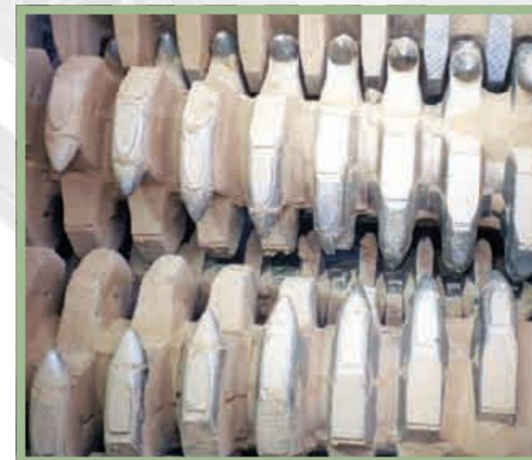
El diseño del rotor con dientes entrelazados permite que el material de menor tamaño fluya libremente pase por los espacios que cambian constantemente que son generados por los ejes que giran a una velocidad relativamente baja.
