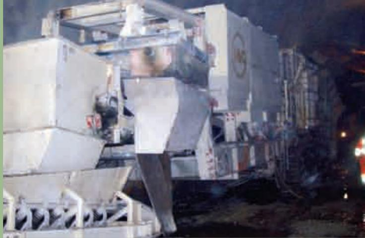
Trituradora de la Serie 850 Completamente Móvil Montado sobre Orugas | Alimentador de Placas D7
