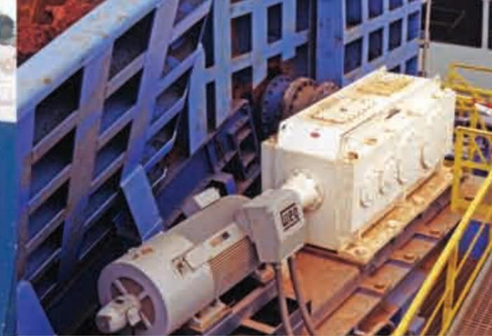
D7 Alimentador de Placas con accionamiento electro-mecánico
