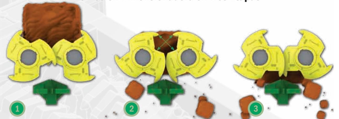
1. En principio, el material es tomado por las caras de ataque de dientes opuestos del rotor. Éstos someten a la roca a una carga en puntos múltiples, induciendo un esfuerzo cualquier debilidad natural.
