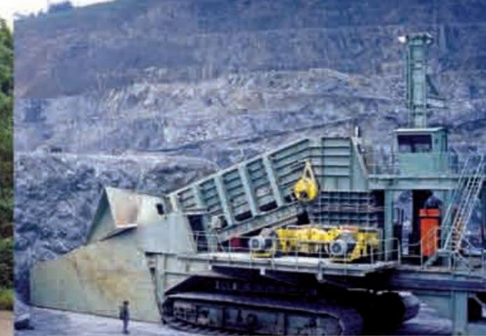
Trituradora de la Serie 1250, Semi-Móvil | Alimentador de Placas D7
