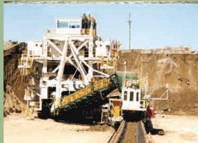
Transportador de Descarga, alimentando el sistema de transporte por tierra
