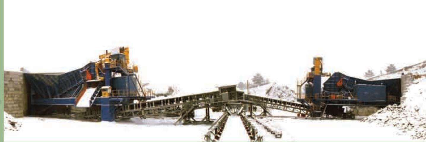
Recubrimiento | Rusia | Entrada: 1.200mm | Salida: -350mm | Capacidad: 3.500TPH
