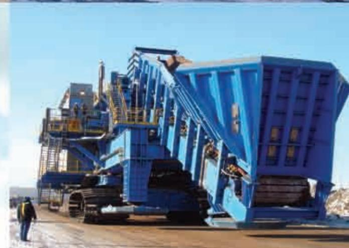
Estación Móvil de Triturado con Mesa de Giro | Chancador de la Serie 1500 | Alimentador de Placas D9
