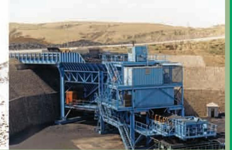
Lignita | China | In: 1,800mm | Out: -300mm | Capacity: 2,500TPH
