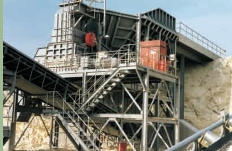
Caliza | Dinamarca | Entrada: 800mm | Salida: -150mm | Capacidad: 450TPH
