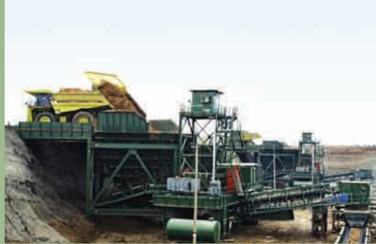
Recubrimiento | Tailandia | Entrada: 1.200mm | Salida: -400mm | Capacidad: 6.500TPH
