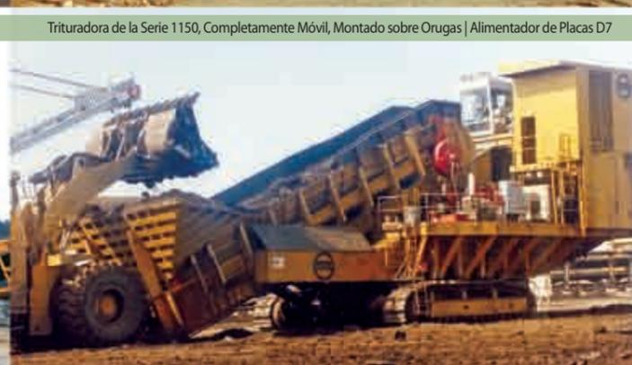
Trituradora de la Serie 1150, Completamente Móvil, Montado sobre Orugas | Alimentador de Placas D7
