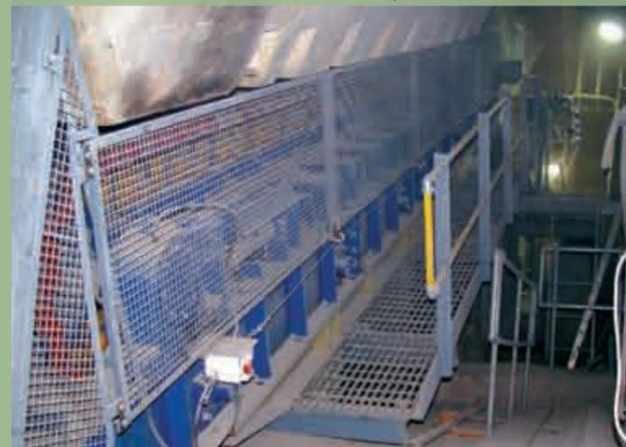
D9 Alimentador de Placas que forma parte de la Estación Móvil de Triturado con Mesa de Giro
