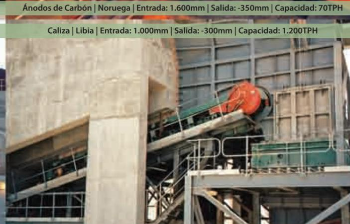
Ánodos de Carbón | Noruega | Entrada: 1.600mm | Salida: -350mm | Capacidad: 70TPH
