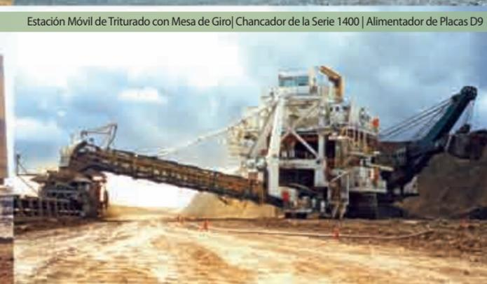
Estación Móvil de Triturado con Mesa de Giro | Chancador de la Serie 1400 | Alimentador de Placas D9
