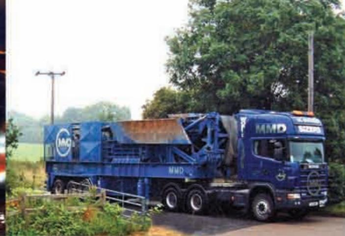
Trituradora de la Serie 625, Montado sobre Remolque, Legalmente Transportable por Carretera
