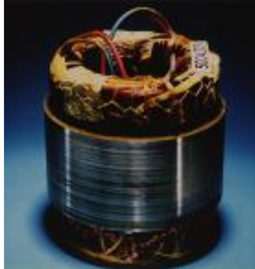
Estator con aislamiento clase F
