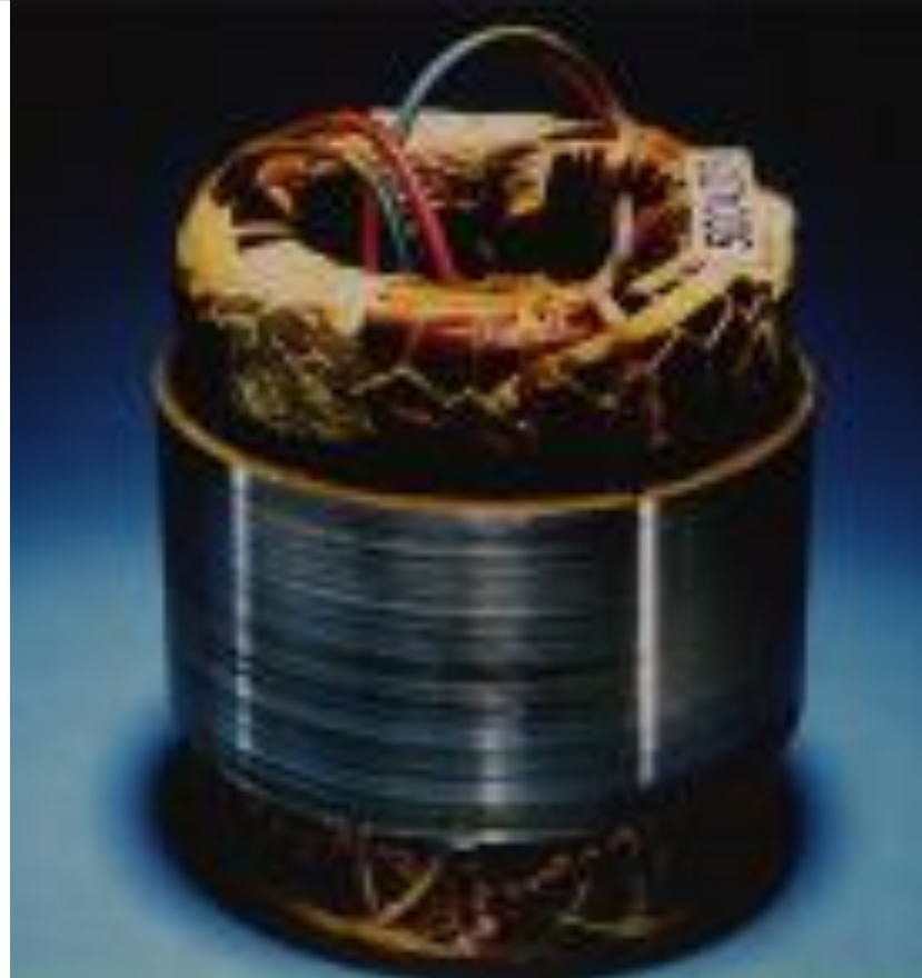
Estator con aislamiento clase F
